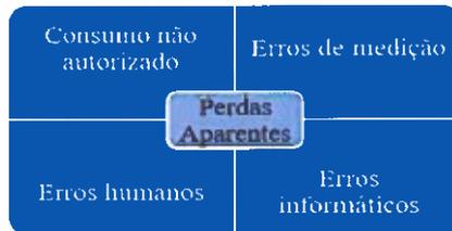
Figura 1. - Principais componentes das perdas aparentes
